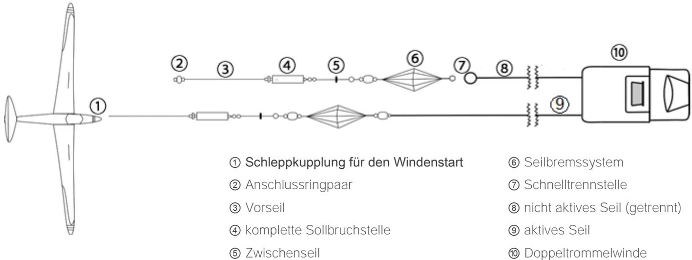
Beim Einsatz von Kunststoff-Schleppseilen sind vom Seilfallschirm abweichende Seilbremssysteme (z.B. Bremsteller, abweichende Seilfallschirmgrößen usw.) zulässig, wenn
